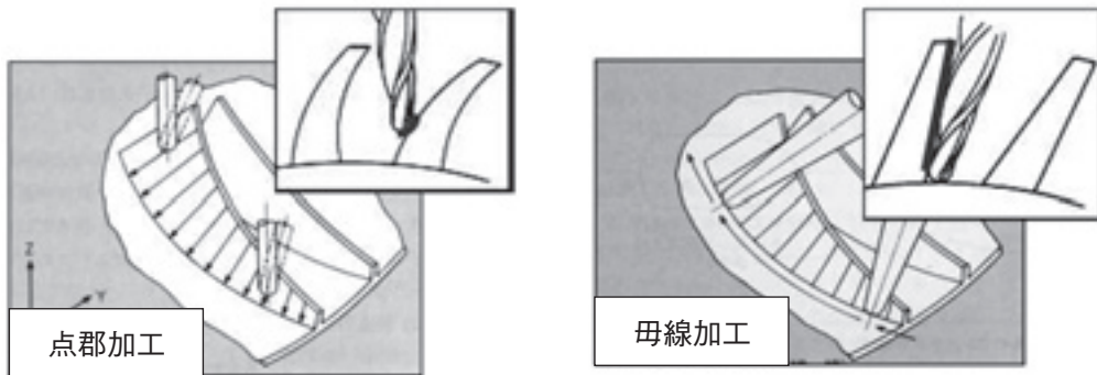
図2 母線加工と自由曲面加工の概念
