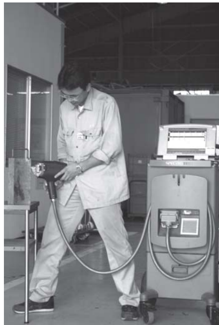
写真1 発光分光分析装置および作業風景
