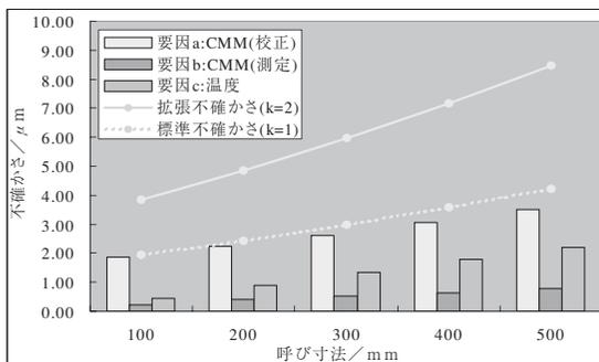
図15-a ステップゲージの測定の不確かさ (前)
