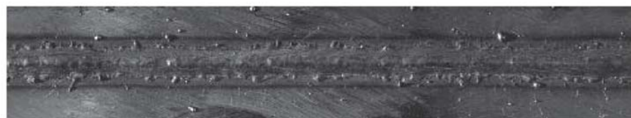
(b) (a)と同じ速度によるハイブリッド溶接のビード外観
