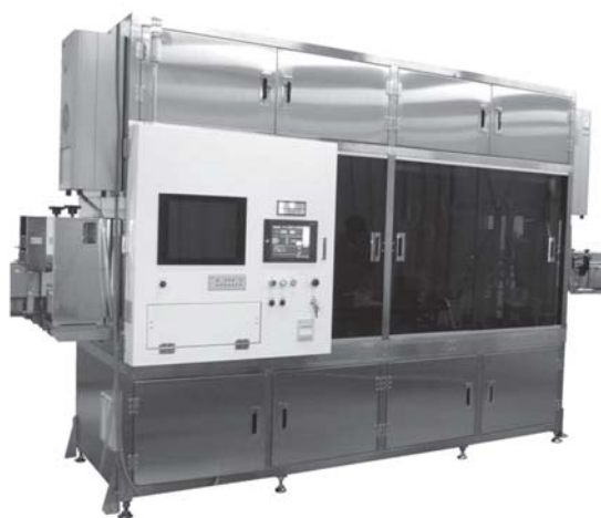
写真 1 実ビン総合外観検査装置
