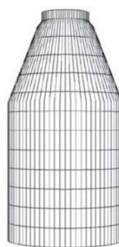
図2 対象ボトル三次元座標のワイヤースケルトン
