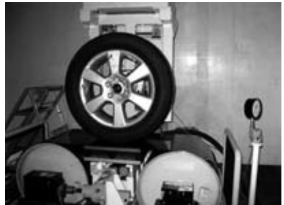
図7 フラットベルト上での ロードホイールのひずみ計測の様子
