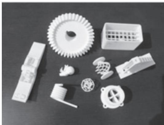
写真1：樹脂粉末のレーザー積層造形物
