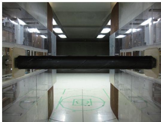
写真2 ケーブル模型の設置例(ヘリカルケーブル)
