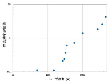
図 10 レーザ出力増加による除去能率の向上
