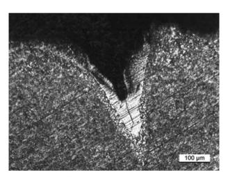
図 13 レーザ照射端部において除去能力が不均一になる例
