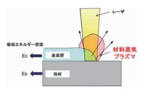
図3 レーザクリーニング技術の基本原理
