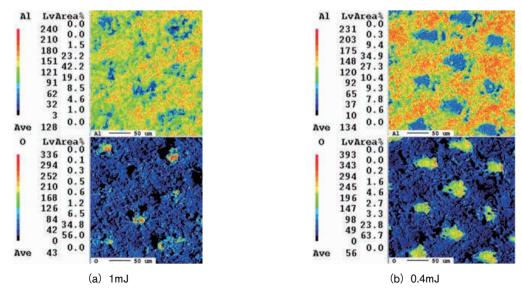
図 7 パルスエネルギーを変化させた場合の EPMA による表面層の除去状況の評価例
