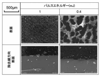
図6 表面観察および断面観察による除去性能の評価
