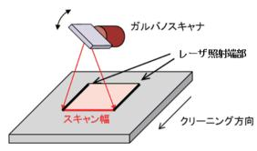
図 12 ガルバノスキャナによるレーザクリーニング
