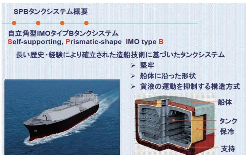
図3 SPB タンクシステム概要<sup>(2) (3)</sup>
