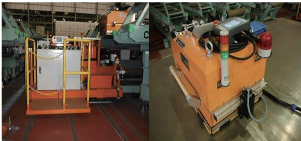
写真 2 自動 X 線検査装置
