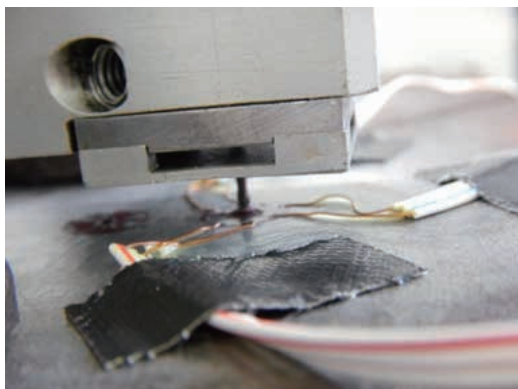
図9 穿孔中の様子 ( \phi 5.14\text{mm} ゲージ)
