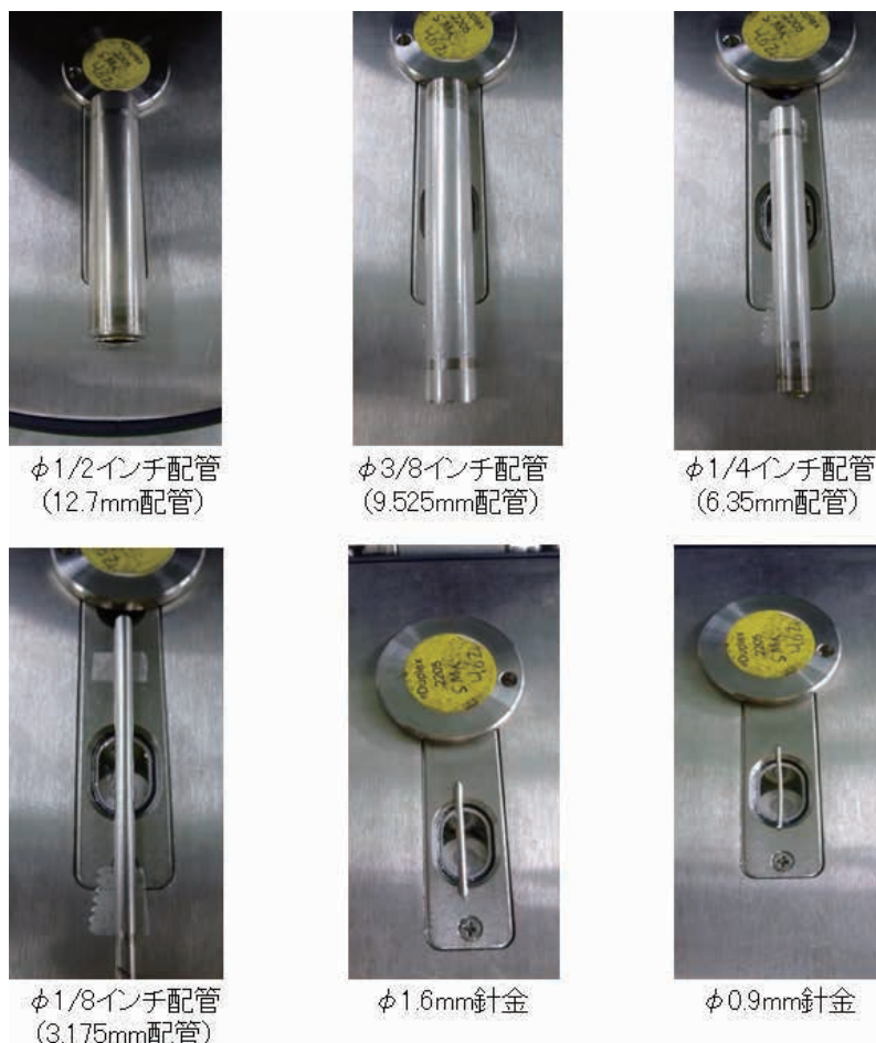
写真4 各試料とX線透過窓との配置
