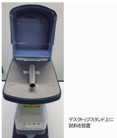
写真3 配管の計測時の様子
