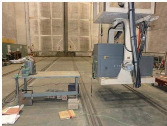
図11 LINATRON M9 の撮影における機器の配置
