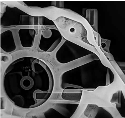
図7 鋳造製品を撮影した透過画像（FPD）
