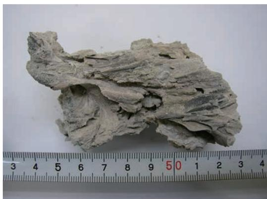
写真 1 採取クリンカの外観
