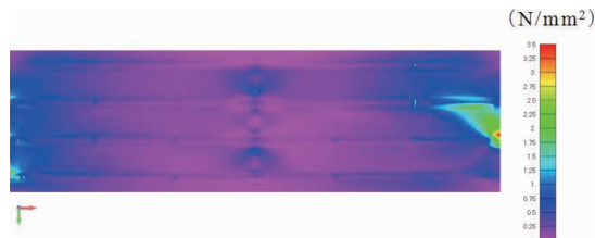
図 9 ケース 7 の床版下面の最大主応力
