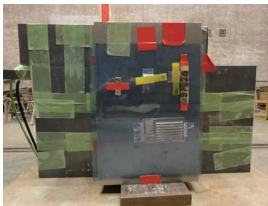
写真 4 各像質計 (IQI) の配置
