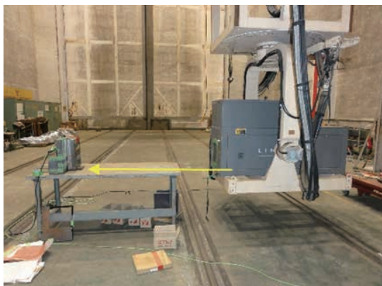
写真 3 高エネルギー X 線照射装置の撮影配置
