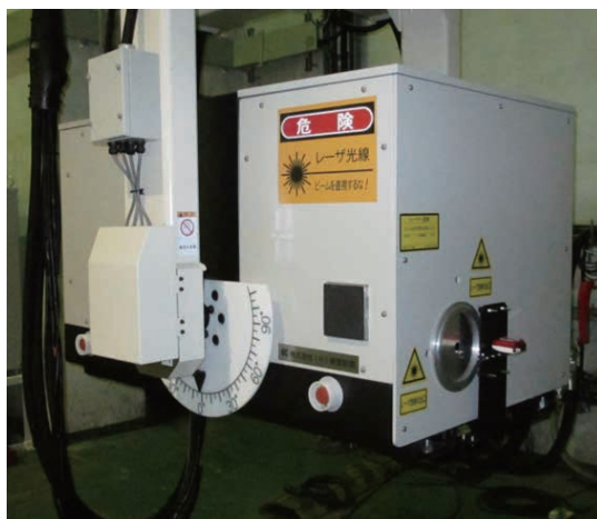
図 10 当社磯子事業所の 0.95MeV-X 線発生装置
