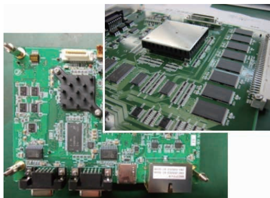
図3 基板モジュールの例
