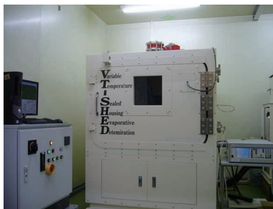
図3 部品用SHED（社内設備：内容積1.6m 3 ）
