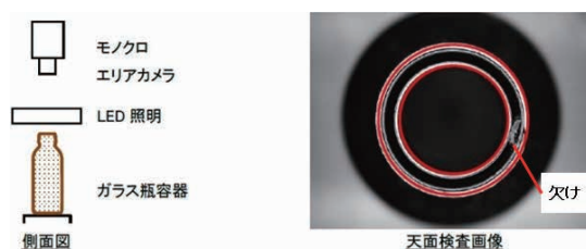
図4 口天面部検査
