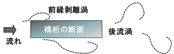
図2 断面まわりの流れの模式図
