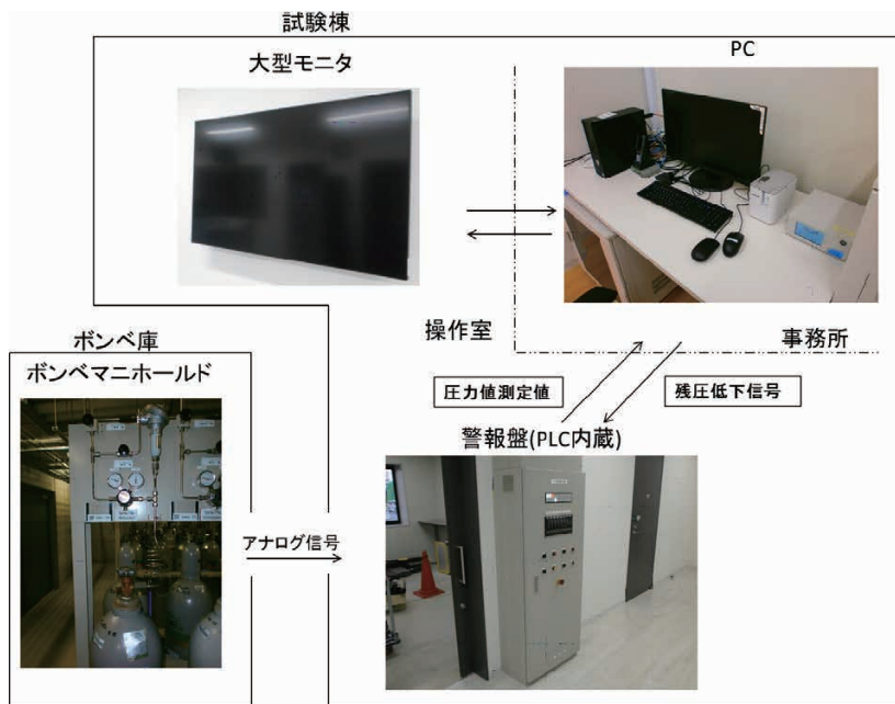
図4 ボンベ管理システムレイアウト (写真: K社納入品)
