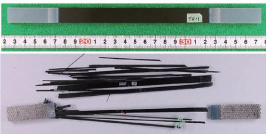
(b) CFRP (一方向材)
