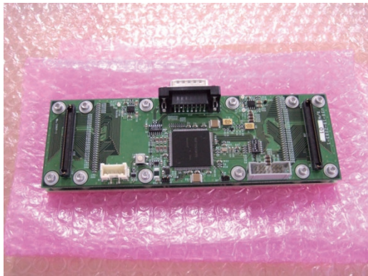
図5 データ計測装置 BBM 写真 (提供：JAXA)
