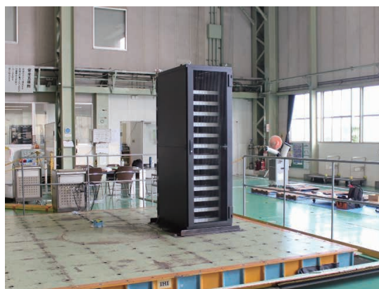
図 3 耐震試験の例
