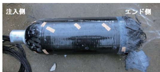
(b) 水耐圧試験後タンク外観
