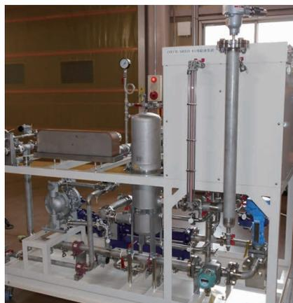
写真 4 燃料給油装置
