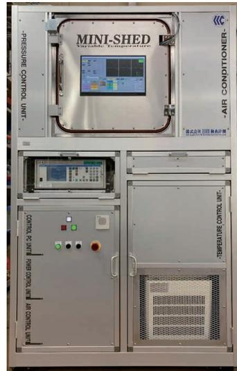
写真 2 MINI-SHED (社内設備：内容積 0.5m<sup>3</sup>)
