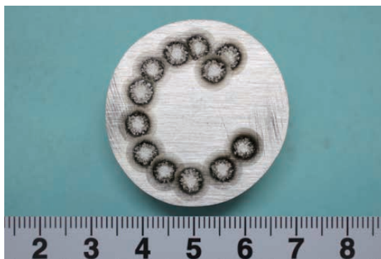
写真3 スパーク法検査後の発光痕
