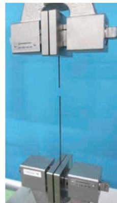
(b) 瞬時破断の試験片外観
