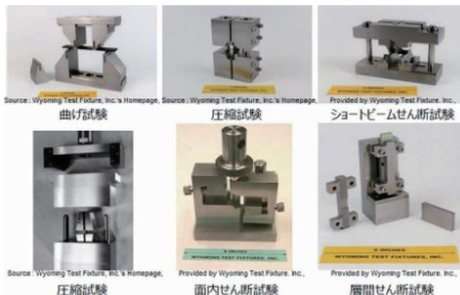
図5 試験治具の例 (ASTM準拠)
