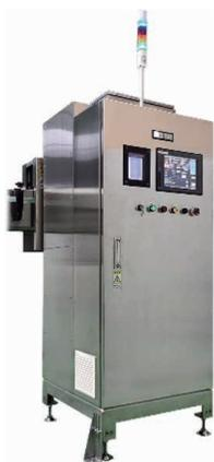
図 7 高精度型 X 線異物検査装置 (TGX30-1020S)
