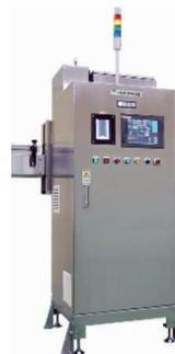
図3 X線異物検査装置 単体機 (TGX30-1010)
