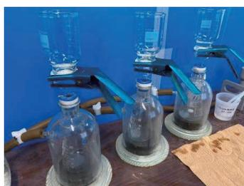
図4 塩酸による鉄の溶出
