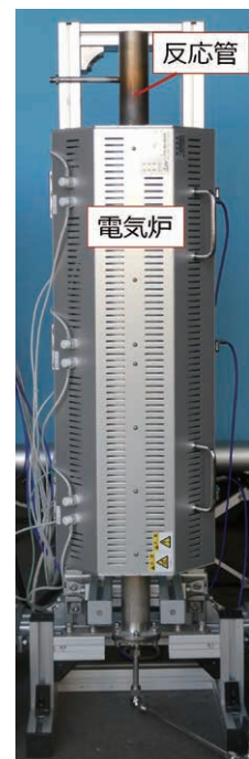
図 11 常圧 SUS 製流動層燃焼炉外観
