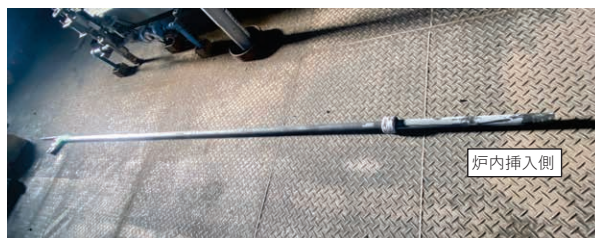
図2 水冷式ガス採取管
