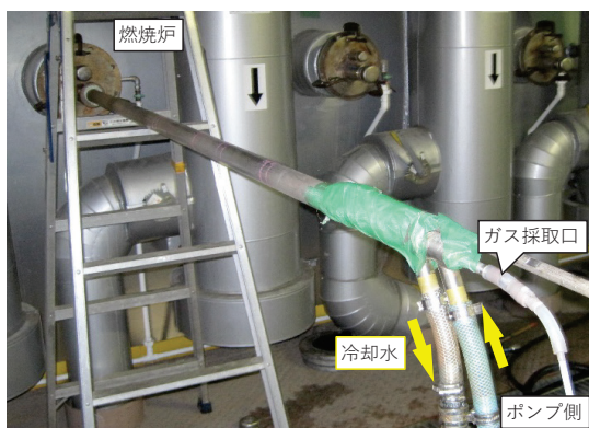
図4 炉内排ガス成分計測
