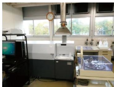
誘導結合プラズマ発光分光分析装置 島津製作所製：ICPS-8100
