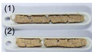
Fig. 7 1223 K における焼結率評価用試料の外観写真 (1) MgO 無添加、(2) 5 wt% MgO 添加
