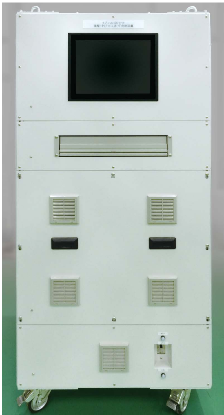
図 9 衛星+PLF 火工品 I/F 点検装置 (SC-OCB)
