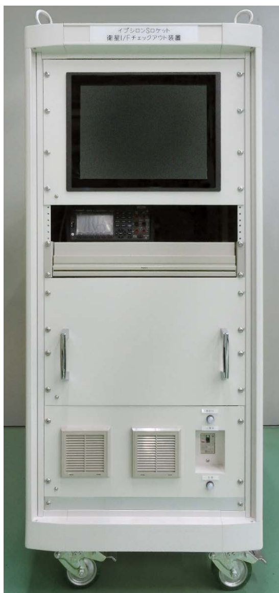
図 6 衛星 I/F チェックアウト装置 (S/C_IF-CHK)
