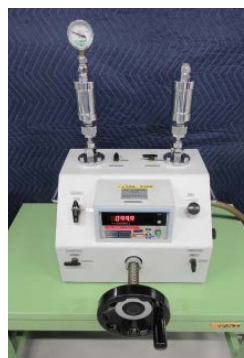
(b) 圧力計 (標準器：株式会社コスモ計器社製 DM-3500)
