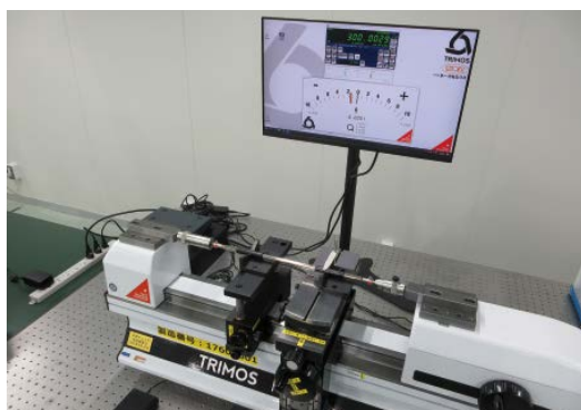
(b) 万能測長機 (TRIMOS 社製 HC5-1000)
