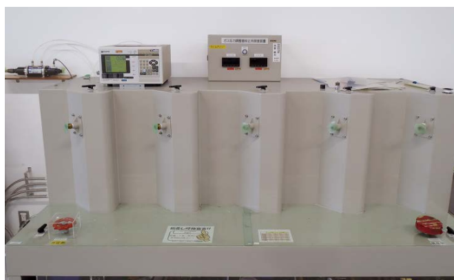
(d) ガス圧力調整器（レギュレーター）検査装置の圧力センサ (長野計器株式会社製 KH15)
