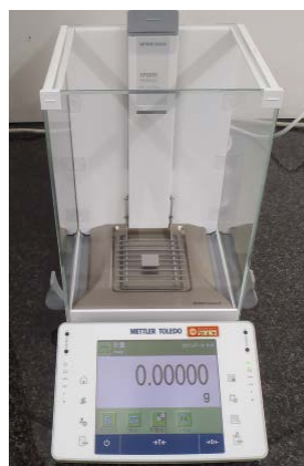
(b) 分析天びん (Mettler Toledo 社製 XPE205DRV)
