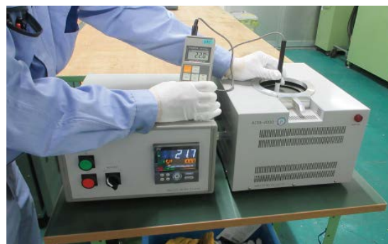
(d) 表面温度計 (標準器：安立計器株式会社製 ACSII-2000)
