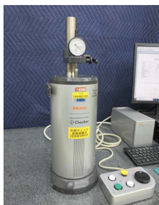
(c) インジケータ検査機 (株式会社ミットヨ社製 HC5-1000)
