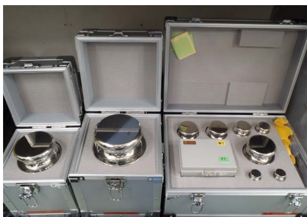
(c) F1 分銅 (株式会社村上天衡器製作所製 F1 級 OIML 分銅)
