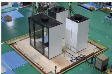
コクヨ株式会社 Web会議向けブース耐震試験 ※WORKPOD FLEX試作品による床固定を行わない場合の挙動検証
