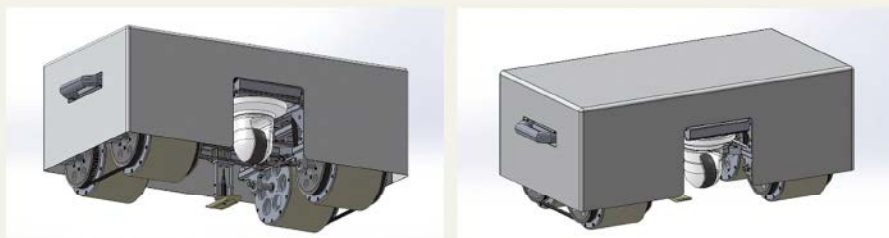
壁面走行装置
