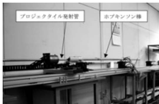
図1-1 ホプキンソン棒を使った衝撃加速度発生装置
