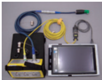
図6 平成17年度 台車枠用 ACFM検査装置の構成
