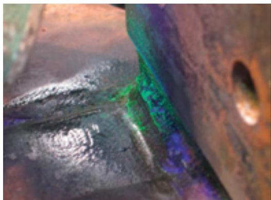
図2 き裂を示す磁粉模様
