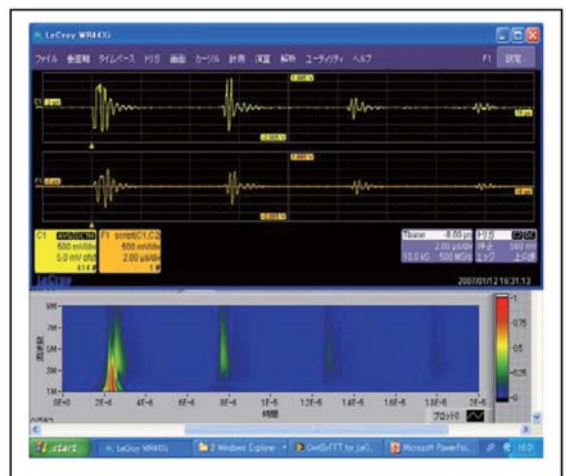
図8 標準試験片 (STB-A 2) 底面エコー観察結果 超音波探傷子：5 Z10N( ジャパンプローブ社製 ) マザーウェーブレット：メキシカンハット
