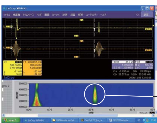
図 13 試験片 2 厚さ計測結果 (マザーウェーブレット：ガボールウェーブレット)
