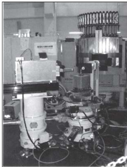
図 13 中性子法に残留応力測定装置と測定例 (Ref.5)
