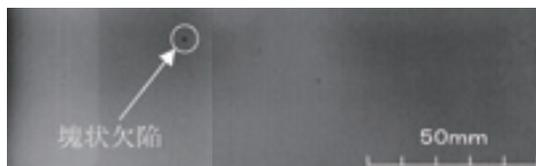
図6 セラミックス球を埋めこんだ継ぎ手のRT検査状況
