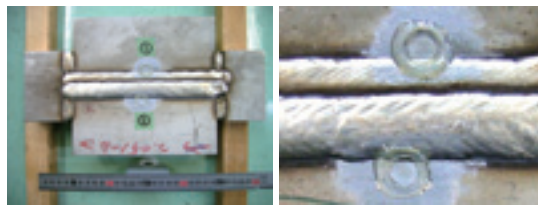
図4 セルを溶接金属(絶縁コーティング済み)にかかる位置に接地したときの接着剤跡
