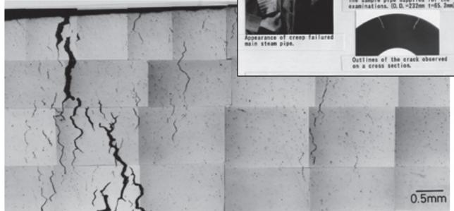
図7 火力発電用ボイラ主蒸気管のクリープ損傷事例
