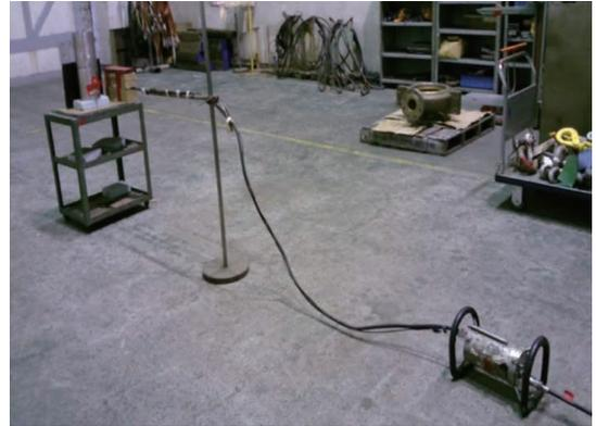
図6 192Ir: γ線による撮影配置
