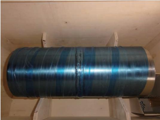
図2 鋼管溶接試験片の外観（保護付）
