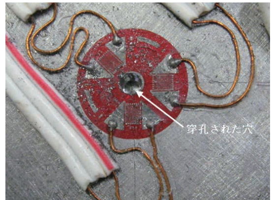
図8 穿孔後のロゼットひずみゲージ
