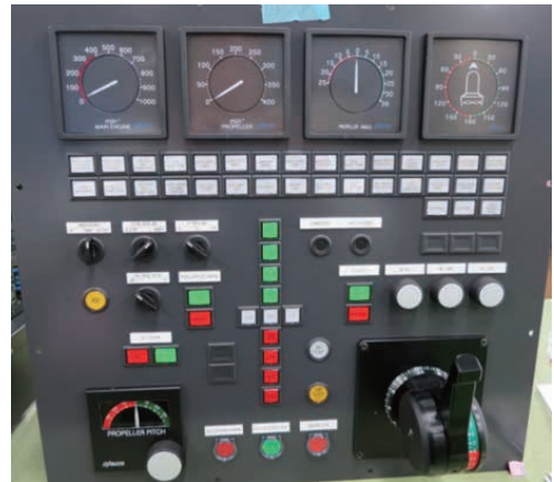
図9 高性能化船の操縦卓 （左右舷に各1面、新型メータ搭載）
