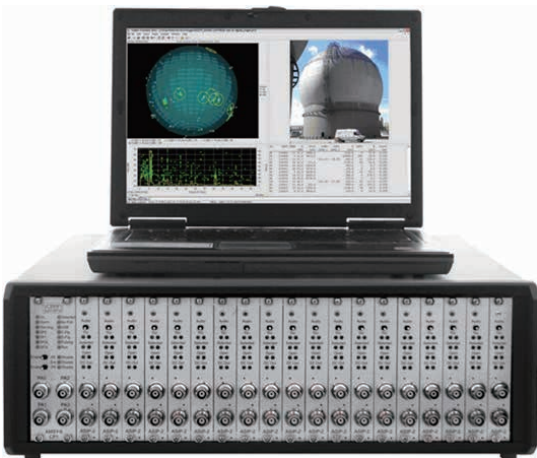
図5 新型 AMSY-6 (AE データ取り込み速度 100,000hits/sec 以上)
