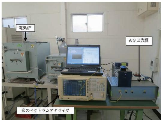
図8 試験装置の設置状況
